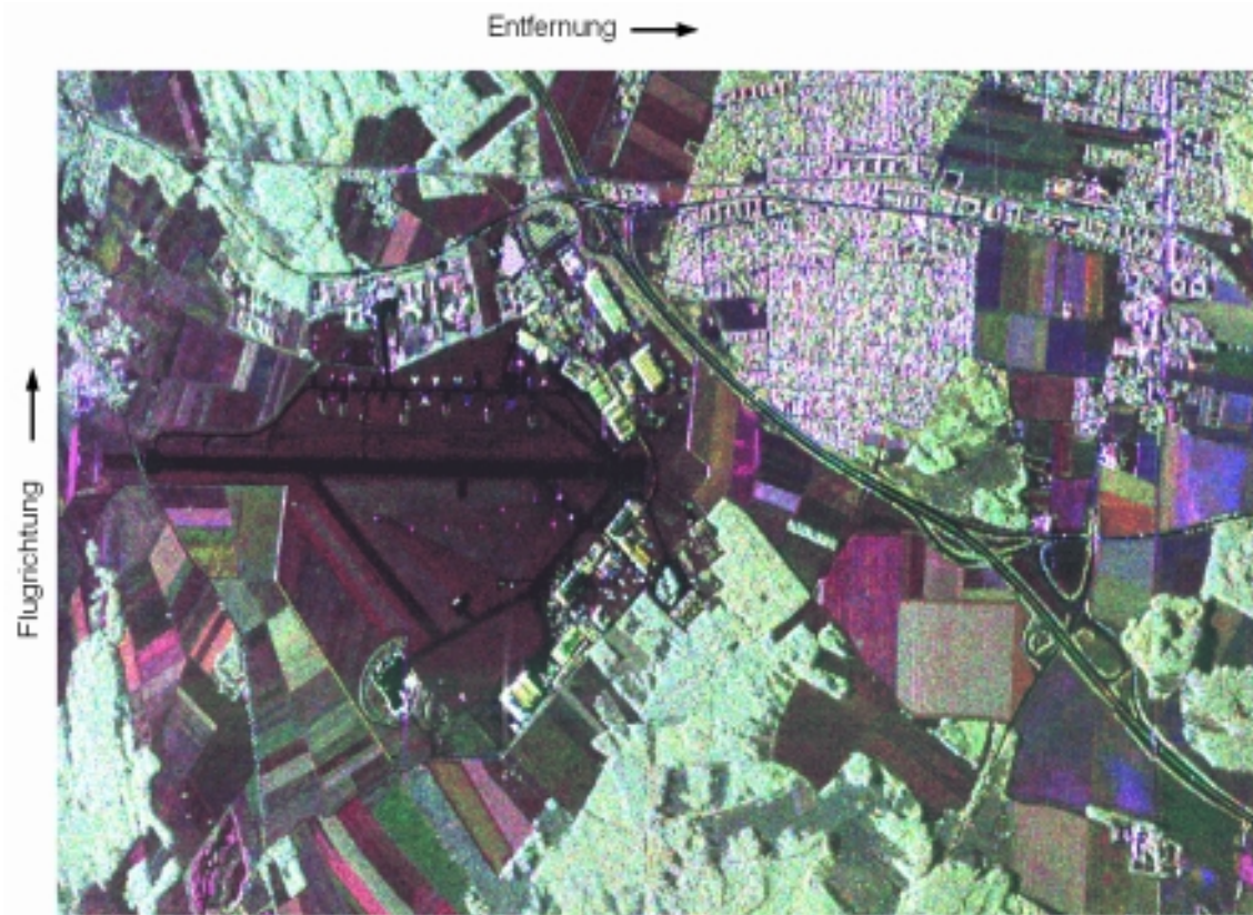
Abb. 1.2: Polarimetrisches SAR-Bild in L-Band mit Falschfarbendarstellung. VV-Polarisation rot, HH-Polarisation blau und Kreuzpolarisationen grün. Die nominalen Sensor- und Verarbeitungsparameter bei dieser Aufnahme sind: Flughöhe: 3830 m, Fluggeschwindigkeit: 81 m/s, Auflösung: 3 \text{ m} \times 3 \text{ m} , Anzahl der Looks: 4. Die Bilddimensionen betragen 3410 m in Azimut \times 4720 m in Entfernung.
