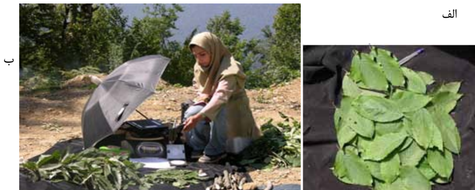
شکل ۴-۴: نمونه آماده شده برای اندازه گیری طیفی (الف)، نحوه اندازه گیری در محل (ب)
