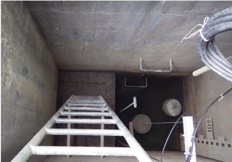
Abbildung 6: Schwimmer an der Messstation Unterhard. (Aufnahme: Jan Seibert)
