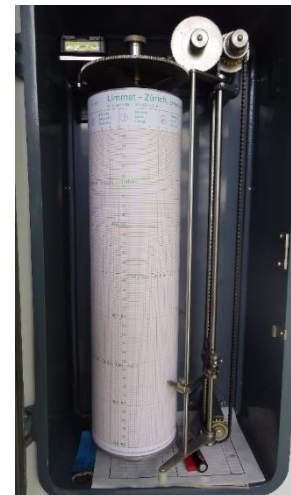
Abbildung 5: Schreiber und Säule an der Messstation Unterhard. (Aufnahme: Jan Seibert)
